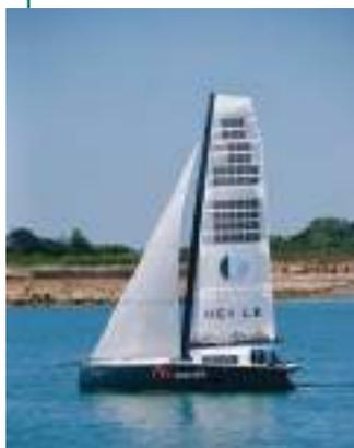
En juin 2022, HEOLE a finalisé son premier prototype en taille réelle (92 m<sup>2</sup>). Les essais en mer montre que la voile est performante et rend le navire positif en énergie; plus besoin d'allumer les moteurs diesel pour recharger les batteries ! Une histoire à suivre à l'heure
